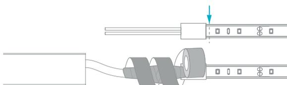
PASSO 5 . Para finalizar, cubra novamente com fita isolante com proteção UV.
