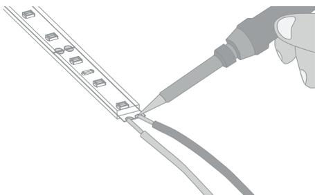
Em seguida, solde um fio vermelho no polo positivo (+) e um fio preto no polo negativo (-). Utilize cabos de cobre com seção nominal de 0,5mm<sup>2</sup>.
