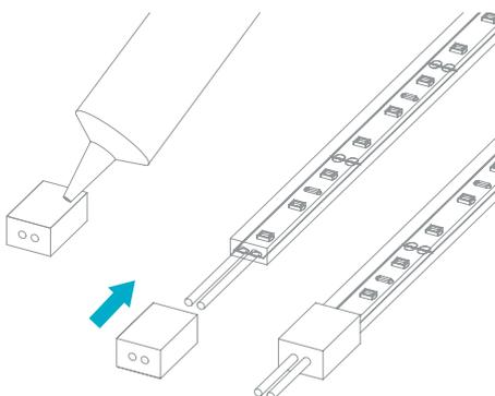
Em seguida, insira os cabos nos orifícios da tampa, deixando espaço para a aplicação do silicone. Após, aplique o silicone até o limite e empurre a fita. Aguarde o tempo de cura informado na embalagem do silicone.
