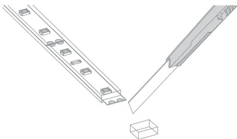
Retire um pedaço da capa de silicone com um estilete, cuidando para não danificar o circuito ou os componentes.
