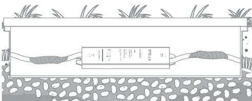
Proteja a fonte e suas emendas, utilizando uma caixa de passagem com drenagem adequada.
