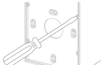
2. Para um acabamento perfeito em alvenaria, a base deverá ser fixada em uma caixa 4x2 ou 3x3 octogonal. Para instalar diretamente na parede, fixe o balizador na superfície desejada, utilizando os parafusos e buchas que acompanham o produto.
