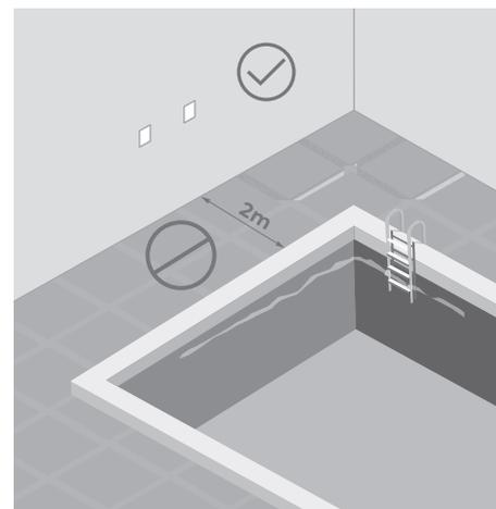
Não instalar dentro ou próximo a reservatórios de água, como piscinas, fontes, entre outros. Respeite a distância mínima de 2 metros, de acordo com a NBR 5410. É necessário impedir a concentração de água ao redor do produto e das emendas.
