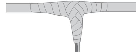
PASSO 5 . Para finalizar, cubra novamente com fita isolante com proteção UV.
