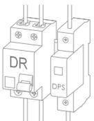
A NBR 5410 recomenda a utilização de um Dispositivo DR e de um Dispositivo de Proteção contra Surtos (DPS). O Dispositivo DR atua protegendo contra choques elétricos causados por fuga de corrente, enquanto o DPS desvia surtos de tensão que podem danificar equipamentos eletroeletrônicos.
