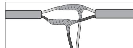
d) Isole toda a emenda adequadamente com fita de autofusão, iniciando e terminando pelas capas.
