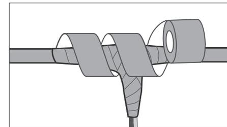
**ATENÇÃO:** Utilize somente cabo flexível multipolar 1kV apropriado para instalações em eletroduto enterrado, conforme NBR 5410. Siga os passos acima para emendas simples ou de derivação.
