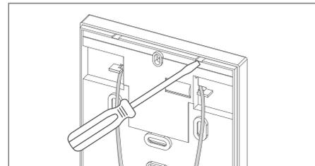
Para um acabamento perfeito em alvenaria, a base deverá ser fixada em uma caixa 4x2 ou 3x3 octogonal. Para instalar diretamente na parede, fixe o balizador na superfície desejada, utilizando os parafusos e buchas que acompanham o produto.
