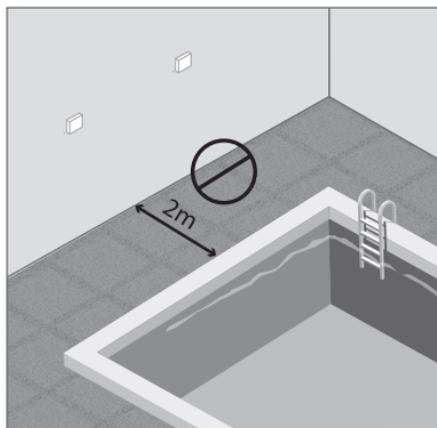
Não instalar dentro ou próximo a reservatórios de água, como piscinas, fontes, entre outros. Respeite a distância mínima de 2 metros, de acordo com a NBR 5410. É necessário impedir a concentração de água ao redor do produto e das emendas.
