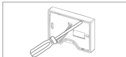
2. Para um acabamento perfeito em alvenaria, utilize a Mini Caixa de Instalação (STH7799), que pode ser adquirida separadamente. Para instalar diretamente na parede, fixe o balizador na superfície desejada, utilizando os parafusos e buchas que acompanham o produto.
