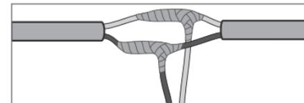
d) Isole toda a emenda adequadamente com fita de autofusão, iniciando e terminando pelas capas.
