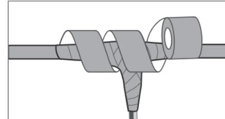
**ATENÇÃO:** Utilize somente cabo flexível multipolar 1kV apropriado para instalações em eletroduto enterrado, conforme NBR 5410. Siga os passos acima para emendas simples ou de derivação.
