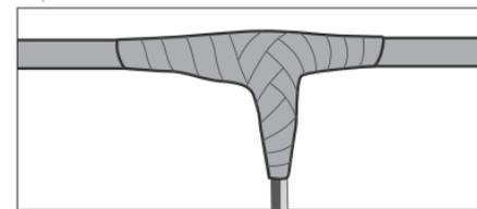
e) Para finalizar, cubra novamente com fita isolante com proteção UV.
