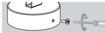
Conecte os cabos do produto à rede elétrica. Fixe o suporte no local desejado com as buchas e parafusos que acompanham o produto e, em seguida, parafuse a canopla ao suporte.
