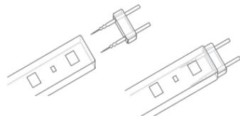
PASSO 2. Utilize silicone nesta área para uma conexão segura em seguida encaixe o alimentador ao terminal.
