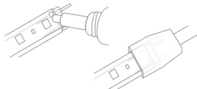
PASSO 3. Isole a conexão adequadamente. Caso a instalação seja feita em área externa ou úmida, isole a emenda conforme a página 07 do manual.
