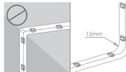
Não instale a fita dobrada em um plano horizontal.
