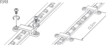
**EMENDA:** para fazer a conexão entre dois pedaços de fita, utilize a emenda repetindo os passos 1, 2 e 3 do item instalação. Isole a conexão adequadamente, caso a instalação seja feita em área externa ou úmida. Utilize fita de autofusão.
