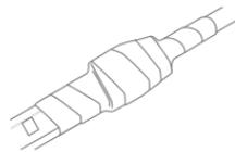
PASSO 4. Utilize o terminal de acabamento ao final da fita. Caso a instalação seja feita em área externa ou úmida, isole a emenda conforme a página 07 do manual.
