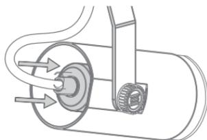
PASSO 2 . Insira a grade antiofusante, pressionando até ouvir o clique. Se um espaço sobrar à frente da lâmpada, utilize o anel de compensação que acompanha o produto, encaixando-o entre a lâmpada e a grade.
