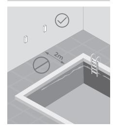
Não instalar dentro ou próximo a reservatórios de água, como piscinas, fontes, entre outros. Respeite a distância mínima de 2 metros, de acordo com a NBR 5410. É necessário impedir a concentração de água ao redor do produto e das emendas.
