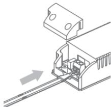
Conecte o cabo vermelho/positivo (+) e o cabo preto/negativo (-) aos respectivos terminais da fonte (vendida separadamente).
