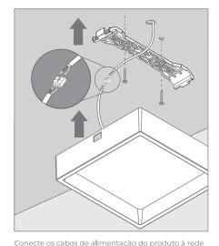
elétrica. Fixe o suporte ao forro com as buchas e parafusos que acompanham o produto. Em seguida, encaixe a luminária no suporte. Certifique-se de manter o conjunto bem firme.
