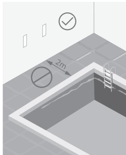
Não instalar dentro ou próximo a reservatórios de água, como: piscinas, fontes, entre outros. Respeite a distância mínima de 2 metros, de acordo com a NBR5410. É necessário impedir a concentração de água ao redor do produto e emendas.
