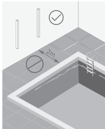
Não instalar dentro ou próximo a reservatórios de água, como: piscinas, fontes, entre outros. Respeite a distância mínima de 2 metros, de acordo com a NBR5410.
