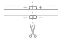
Retire um pedaço da capa de silicone com estilete, cuidando para não danificar o circuito ou demais componentes.
