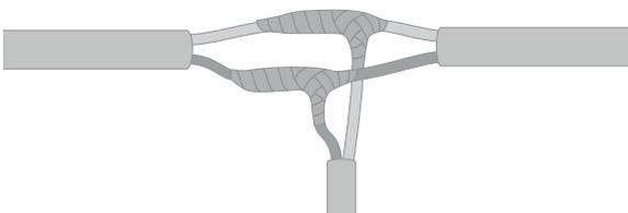
**PASSO 4 .** Isole toda a emenda adequadamente com fita de auto-fusão, iniciando e terminando pelas capas.
