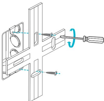
Desacople o suporte de fixação e parafuse-o em uma caixa 4x2 ou 3x3 (octogonal). Dois parafusos acompanham o produto.
