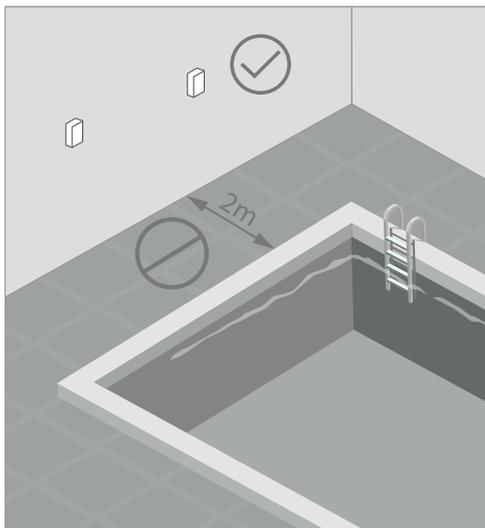
Não instalar dentro ou próximo a reservatórios de água, como piscinas, fontes, entre outros. Respeite a distância mínima de 2 metros, de acordo com a NBR 5410.
