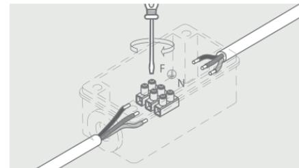
**PASSO 5.** Parafuse a capa protetora do conector novamente e empurre o conjunto para dentro da arandela.
