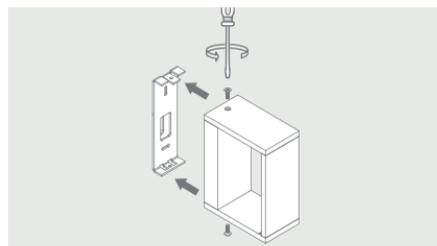
**PASSO 2.** Em seguida, utilizando os parafusos que acompanham o produto, fixe a base no local desejado, passando o cabo da rede elétrica pelo orifício central.
