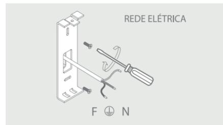
**PASSO 3.** Puxe a alimentação da arandela para fora e remova os parafusos que protegem o conector.
