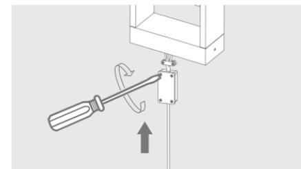
**PASSO 6.** Finalize encaixando a arandela na base e apertando os parafusos laterais.
