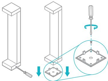
Remova os parafusos laterais da luminária para liberar a base de fixação. Em seguida, utilizando os parafusos e buchas que acompanham o produto, fixe-a no local desejado.
