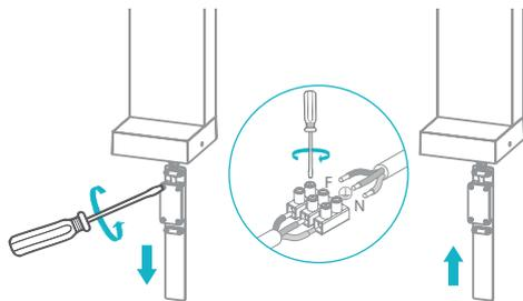
Puxe a alimentação da luminária para fora da mesma, remova os parafusos que protegem o conector sindal, após realize a emenda dos fios da luminária com os da rede elétrica, atentando-se para a posição correta dos mesmos (fase e neutro). Aparafuse a capa protetora do sindal novamente e empurre o conjunto para dentro da luminária afim de que fique o mais longe possível do solo.
