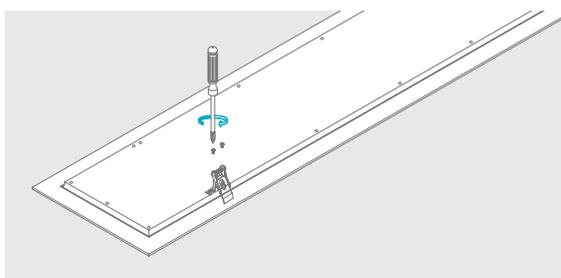
Parafuse as presilhas no local designado, utilizando apenas os parafusos que acompanham o kit de presilhas, com torque não superior a 1Nm. Se aplicar aperto demasiado ou utilizar parafusos diferentes dos originais, danificará o produto e invalidará a garantia.
