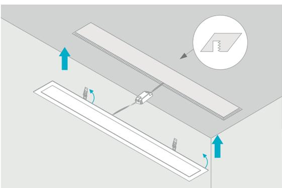
Faça o corte no forro, utilizando as dimensões de corte 130mm x 1200mm. Cuidado para não utilizar a medida externa do produto por engano.
