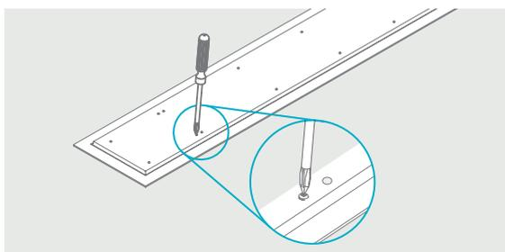
Localize a posição para a instalação das presilhas, com dois furos lado a lado, na parte traseira do painel.
