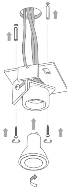
4) Encaixe a luminária no suporte e fixe com os parafusos laterais.
