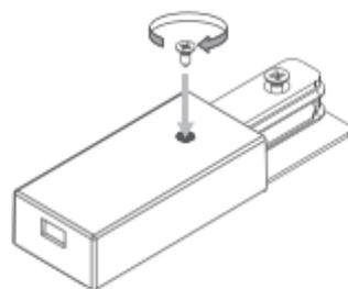
3) Conecte o trilho ao conector e aperte o parafuso B para fixar. Instale-o segundo as orientações do respectivo manual. É necessário apenas um alimentador por circuito.
